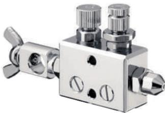
細丸吹き、外部混合噴霧。ノズル口径φ0.6で少量の液体を噴霧するのに最適です。複数個を連結し、エアと液の入口を一箇所で使用することもできます。エア調節器付で粗い霧にもできます。
