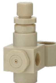
広角丸吹のピストン作動エア、霧化エア分離式です。うず巻き気流で微粒化が良く、キャップの汚れ、目詰まりを防止します。
