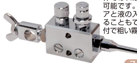
丸吹き、内部混合噴霧。液体の吸引力が強いので、低粘度の液体であれば吸い上げ式で噴霧も可能です。複数個を連結し、エアと液の入口を一箇所で使用することもできます。エア調節器付で粗い霧にもできます。
