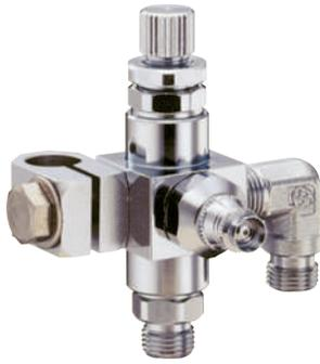
小さい丸吹きです。エア消費量が少なく微細なスプレーができ、印刷マーキング・加湿などに適します。製品かスプレーガンを移動させれば線引きができます。分離型のHM-6Pもあります。※スプレーパタンφ2~φ40（吹付距離、エア圧、液量の調節による）
