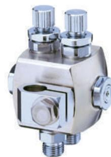
HM-4Tと同タイプの丸吹きです。液量調節器が2個付きで液量は左右別々に調節できます。本体アルミ製で無電解ニッケルメッキ付。腐食性の液体（酸、アルカリ）は使用できません。
