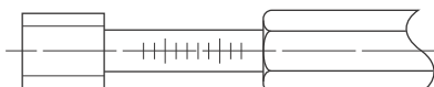
深さ検査用ねじプラグゲージ Thread plug gauge for deep holes
