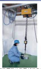
吊り荷を直接ハンドリングして位置決め作業ができます。 エア駆動で滑らかな操作感が特徴です。
