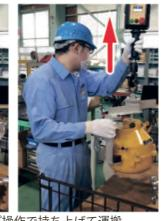
ワーク操作で治具をスムーズに装 着しグリップ操作で持ち上げて運搬
