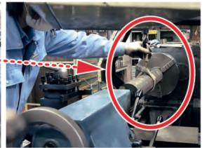
ワーク操作で微細な調整を行いながらワークを旋盤に固定
