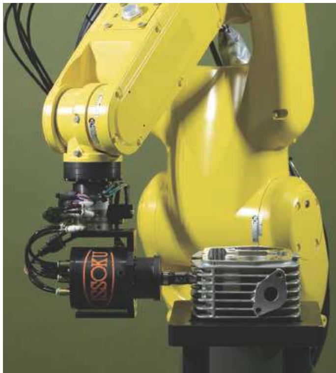
ねじプラグゲージで タップ穴の通り検査 thread plug gauge
