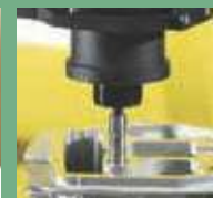
片ロプラグゲージで 穴の通り止り検査 Single-ended Go and NoGo plug gauge
