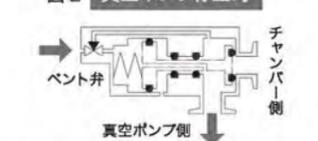
電磁弁非通電時(真空ポンプ停止時)はバルブは閉となり、チャンバー側は真空封止されます。ベント弁は開となり、真空ポンプ側は大気圧となります。
