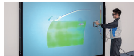
ARを利用した塗装シミュレーター Painting simulator using AR
