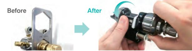
本体は塗料経路とピストン室が分離した構造になっているため、ニードル弁やニードル弁パッキンなど摺動部の摩擦度合いを検知しやすくなります。また、ニードル弁パッキン部のカバーがニードル弁パッキンの増し締め工具となっています。塗料漏れの早期発見が可能となるだけでなく、分解せずにニードル弁パッキンの増し締めを行うことができます。
