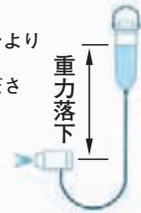
ごくわずかな吸引力はありますが、一般には液体に圧力がかかっている必要があります。粘度が高い液体以外は、液体を入れた容器をスプレーガンと同じか少し高いところに置けば大丈夫です。ちなみに水の場合ですと、1mの落差で0.01MPaの圧力がかかります。粘度が高い場合、容量が大きいものを使いたい場合、床置きしたい場合は圧送タンクを用います。
