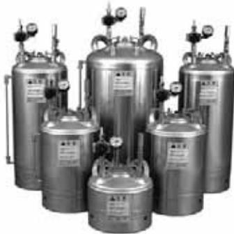
圧送タンクは、液を入れた密閉式の容器にエアを送り込み、その圧力で液体を押し出すようになっています。必要以上に液圧をかけすぎると量が出過ぎるため、スプレーガンの出口で量を絞ることになります。スプレーガンの液量調節は、ノズルとニードルの隙間を調節することで行っていますので、量を絞るためには隙間を小さくしなければなりません。量を絞るためにノズルとニードルの隙間を狭くし0.1mm程度の隙間に濃い液体を通そうとすると、出方が不安定になりやすくなります。圧送タンクを使う場合は、液圧をかけすぎないように注意して下さい。液体の粘度や、どのくらいの量を出したいのかにもよりますが、通常は0.02MPaから0.1MPaくらいです。
