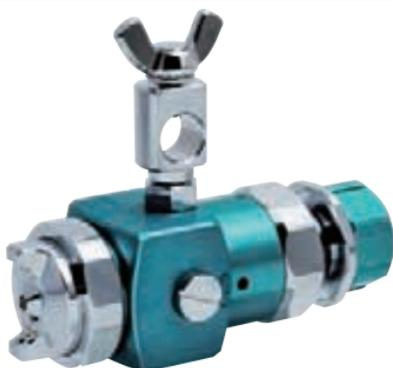
霧化エアを低圧(0.05MPa)で高微粒化されたミストを発生させる構造とし、液体の飛散、跳ね返りを抑え、高い塗着効率を発揮します。
