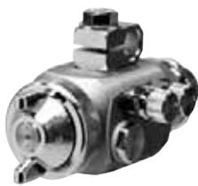
沈殿する液体の場合、スプレーガンのノズルの内部に沈殿が起ると、詰まって液体が出なくなります。これを防ぐため吹き付け停止中も液体を動かし続ける必要があります。これには、液を攪拌装置付きの容器に入れ、ガンへの液供給経路のほか、ガンから容器へ戻る経路を設け、ポンプによって常に液を循環させます。スプレーガンも、スプレー停止時に液がタンクへ戻っていくための液出口がついた循環仕様のものを使用します。
