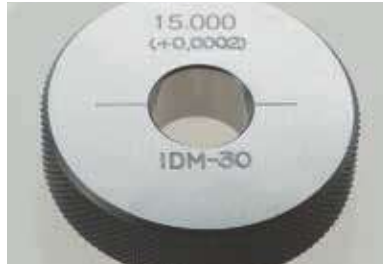
マスタリングゲージ Master ring gauge
